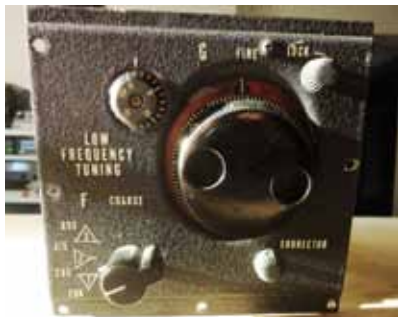
Bild 2: Das Low Frequency Modul sichert den Betrieb auf 472 KHz
