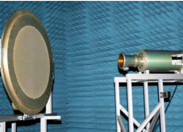
Abb. 12 - Frequenzselektiver Reflektor M7 mit Ka-RX Feed
