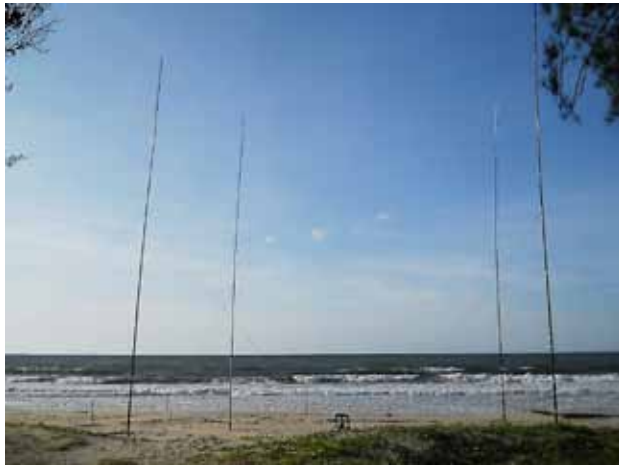
Foto 5: 4-square Antenne für 40m
