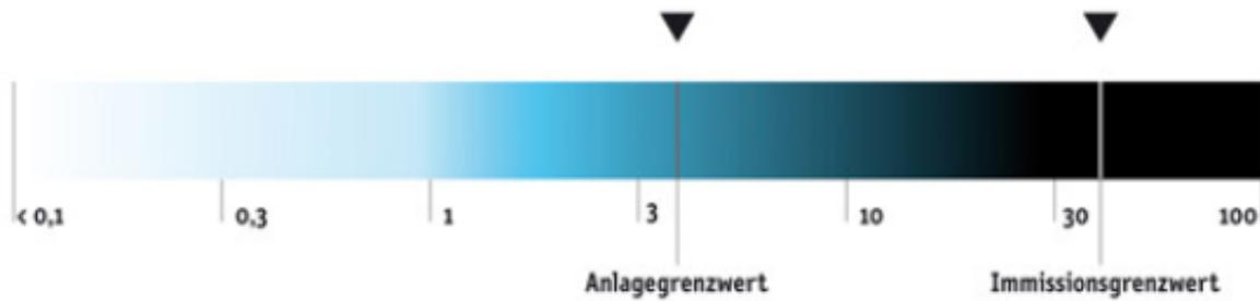
Skala der elektrischen Feldstärke in Volt pro Meter (V/m).
